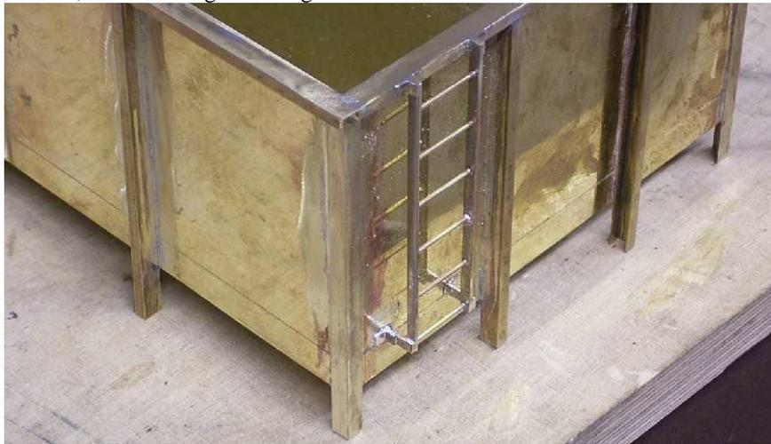
5. Montage der Griffstangen. Am Wagenkasten sind zwei Griffstangen für Rangierer, diese sind 40 mm lang und stehen 5 mm vom Wagenkasten ab. Die Position ist rechts in Fahrtrichtung, außen am Eckprofil, 15 mm vom Fahrzeugboden. Außerdem sind am Saumeisen, rechts von der Leiter und auf dem Saumeisen an der Seitenwand je eine Griffstange von 15 mm Länge. Diese stehen 4 mm vom Wagenkasten ab.
