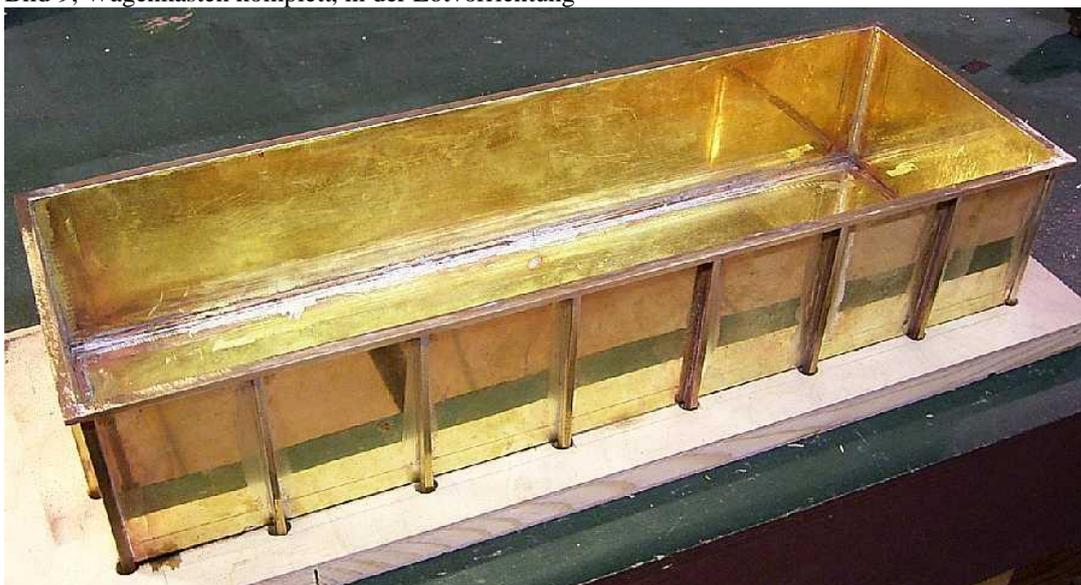
2. Montage der Eckprofile. Die meisten Messingwinkelprofile haben in der Innenecke einen kleinen Radius. damit das Profil auf der Ecke gut aufliegt, müssen an dem Wagenkasten die Kanten gebrochen werden. Die Winkelprofile werden unterhalb der Saumeisen angesetzt.
