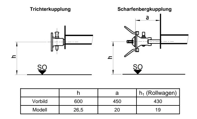
Die Standardkupplungen für sächsische Schmalspurfahrzeuge sind die Trichterkupplung und die Scharfenbergkupplung.
